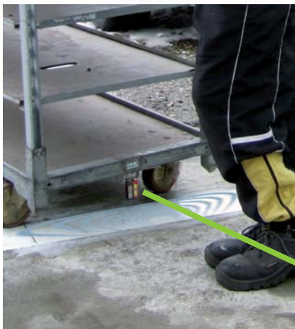
identGALA 3000: Automatische Prüfung bei Überfahren der Bodenantenne
